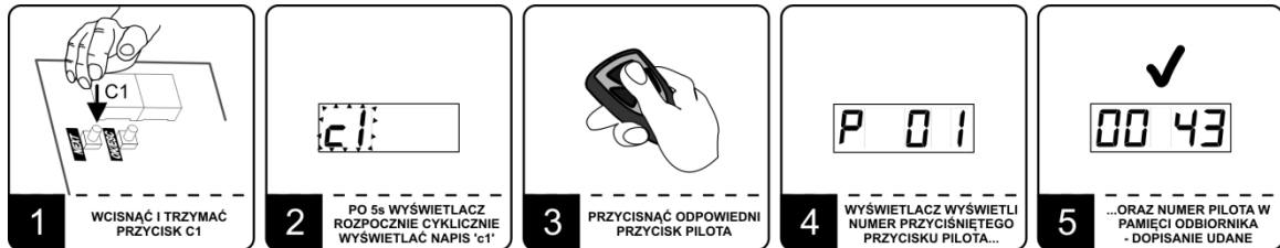
Rys. 4 Przykład dopisania przycisku numer 1 do kanału C1 odbiornika za pomocą przycisków C1.
