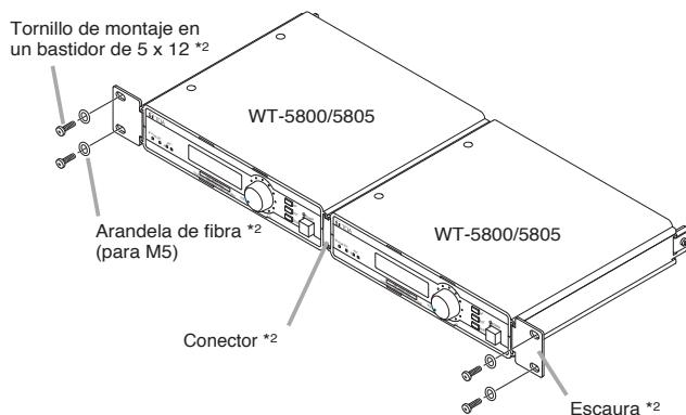
\*2 Partes componentes del MB-WT4.
