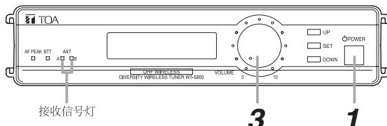
第一步：打开电源，LCD显示屏将会显示接收到的频率和RF/AF等级。
