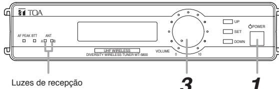
**Passo 1.** Ligue a alimentação e a tela LCD exibirá a frequência de recepção e os níveis RF/AF.
