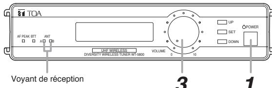
**Etape 1.** Mettre sous tension, puis l'écran LCD affiche la fréquence de réception et les niveaux RF/AF.
