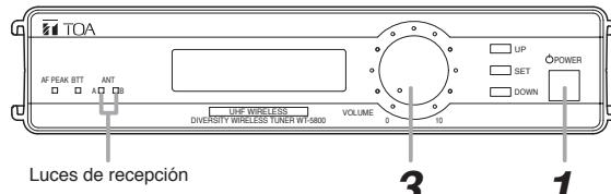
**Paso 1.** Conecte la alimentación, y la pantalla LCD mostrará la frecuencia de recepción y los niveles de RF/AF.
