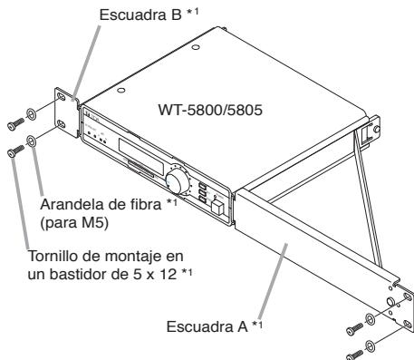
\*1 Partes componentes del MB-WT3.
